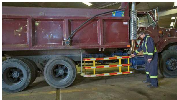
Angles morts d'un camion; protections latérales. Source : SAAQ
