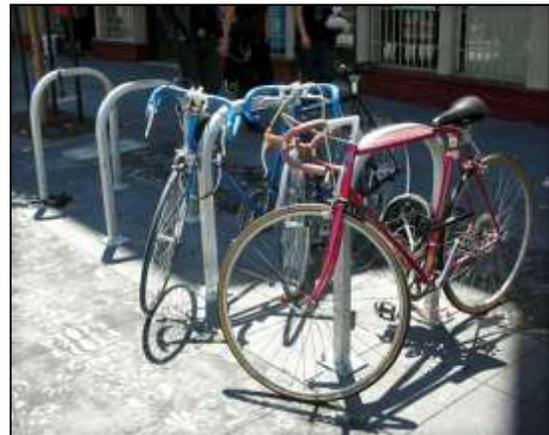
Pour les deux types de supports, un **fini en acier inoxydable** est fortement recommandé. Le coût unitaire est un peu plus élevé à l'achat, mais le produit résiste mieux à la corrosion et à l'usure que la plupart des autres matériaux de finition.
