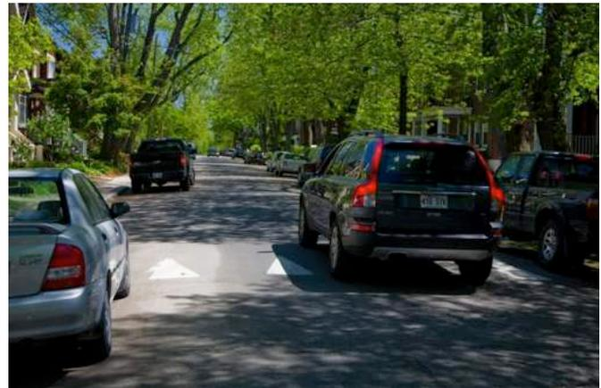
**La présence de dos d'ânes allongés obligent les véhicules à circuler lentement (généralement  $\leq 30$  km/h)**
