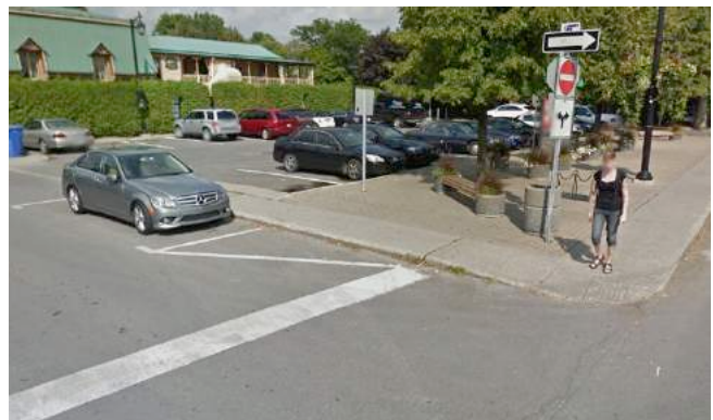
Exemple de marquage en secteur commercial visant le dégagement visuel de l'intersection – arrondissement de Verdun
