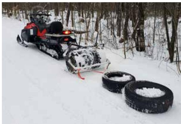
Les Amis des sentiers de Bromont utilisent deux pneus attachés ensemble à la file indienne pour réduire le mouvement sur l'axe Z (en hauteur).
