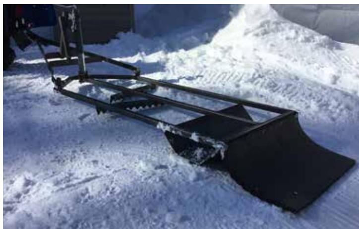
Gratte avec lames en V et plaque/tapis de compaction
