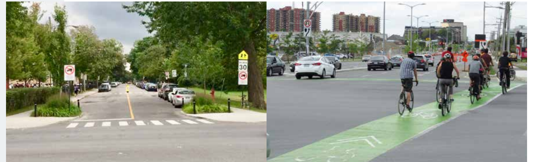
Saillies de trottoir de part et de la rue qui diminuent la durée de traversée des piétons et force le conducteur à réduire sa vitesse en virage. Rue Frigon à l'angle de la rue De Salaberry
