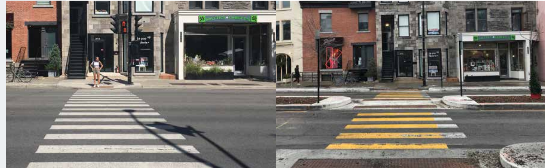
Avant | Passage à mi-bloc muni d'un feu piéton sur la rue Saint-Denis
