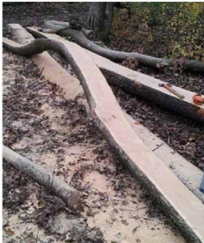
Tronçonneuse portable pour le rabotage des troncs sur le terrain. Photo : Chad Landowski/Traction Trailworx
