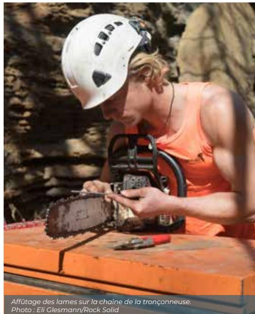
*Affûtage des lames sur la chaîne de la tronçonneuse.
