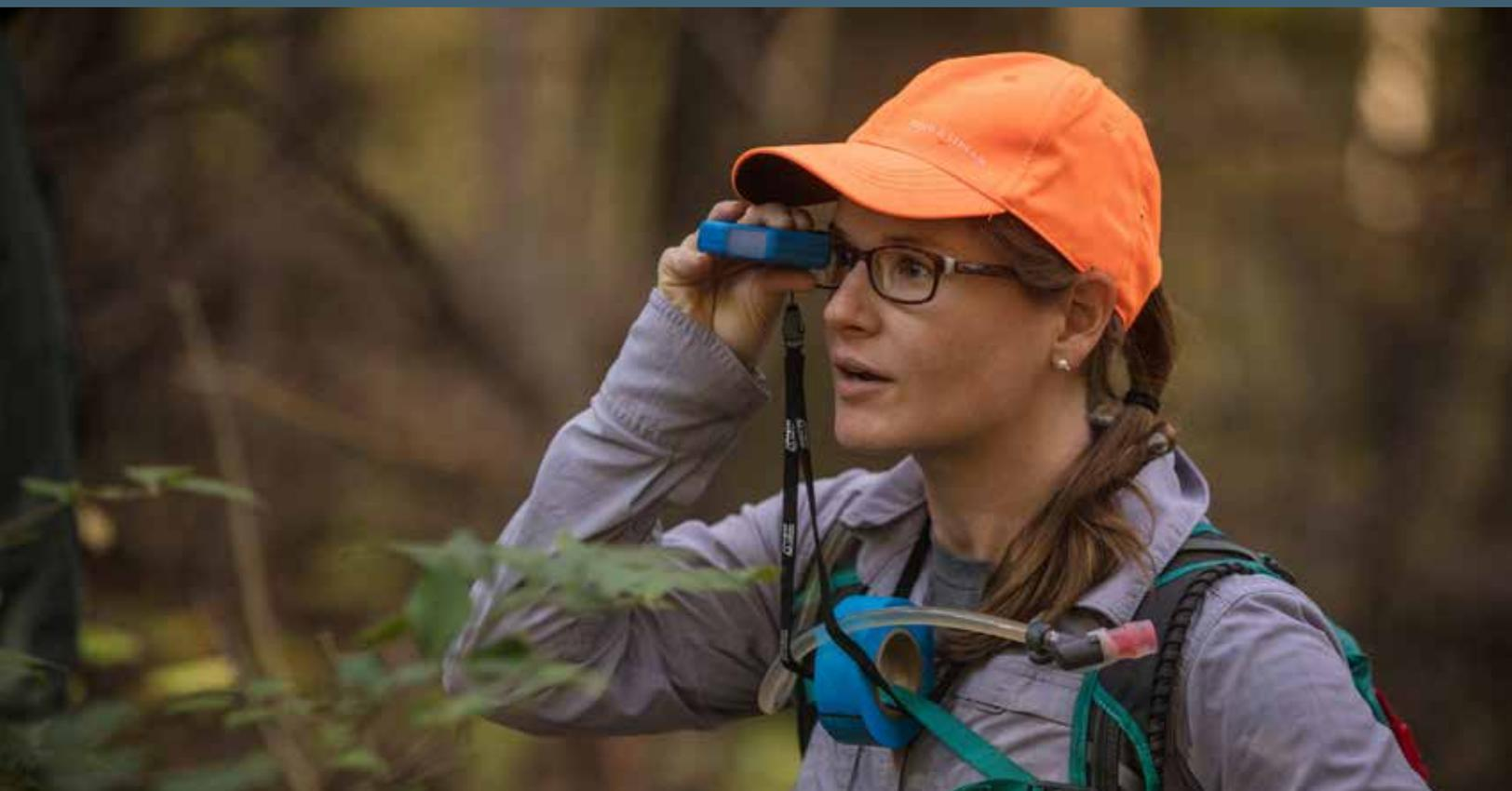
Un constructeur de sentiers utilise un clinomètre numérique pour mesurer les pentes et déterminer l'inclinaison des sentiers sur le terrain, dans le cadre d'un projet à Chattanooga, dans le Tennessee.
