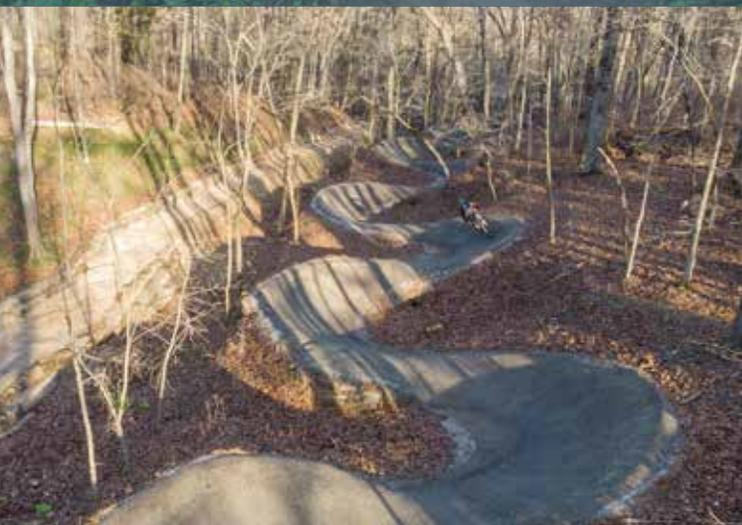
Sentier à virage relevé fluide recouvert d'enduit d'usure du Slaughter Pen à Bentonville, en Arkansas. Photo : Eli Glesmann/Rock Solid
